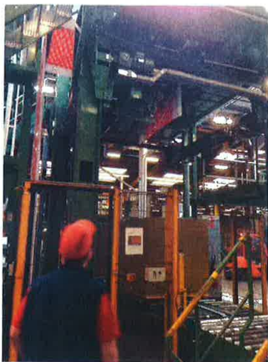
Hættestrækken hvor pallerne får en plastik-hætte på til at beskytte produkterne for vejr og vind. På billedet er også Danny, ham fik jeg et rigtig godt venskab til. En utrolig dygtig maskine fører med sans for detaljer.
